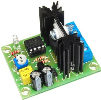
AR163 ermöglicht Softstart (den Sanftanlauf) von Geräten, die mit Gleichstrom DC 9-24V betrieben sind, wie z. B. Bürsten-Gleichstrommotoren oder Beleuchtung.
