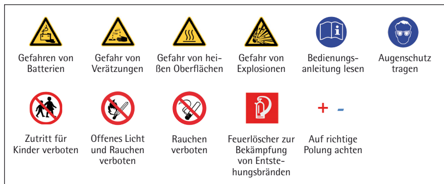
Bild 1: Je nach Speichertechnologie, Größe und Aufstellungssituation können diese oder ähnliche Warn- und Sicherheitshinweise und Kennzeichnungen direkt am Speichersystem oder im Zugangsbereich notwendig werden. Die Hinweise sind in geeigneter Weise durch ein Symbol und zusätzlich mit der Beschreibung von Art und Quelle der Gefahren, den möglichen Folgen bei Nichtbeachtung sowie den Maßnahmen zur Vermeidung aufzuführen. Die Vorgaben der Hersteller sind zu beachten.
